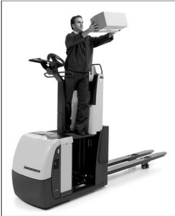
Está compuesta por una cabina donde se sitúa el conductor, delante de la cual se encuentran las horquillas fijas. Las cargas unitarias se apilan en forma de bloques separados por pasillos a fin de permitir un fácil acceso a los mismos. Se emplea este sistema cuando la mercancía se recibe en grandes cantidades de distintas referencias, y la misma está paletizada.
