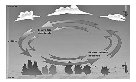
La energía eólica es energía solar. El Sol provoca diferentes temperaturas en el aire que rodea a la Tierra, lo que provoca que haya regiones con altas y bajas presiones. Estas zonas de presión junto con el movimiento rotativo de la Tierra, crean los principales sistemas de vientos.
