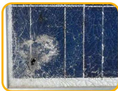
Mala manipulación o izado de un panel o módulo fotovoltaico
